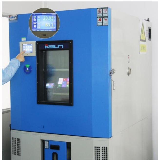
图 5-3 高低温老化测试图
